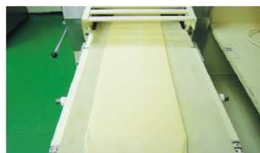
3.法式裹油法 3折x2次壓延成0.4cm片狀
